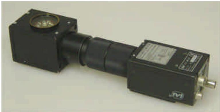
**Abb 3:** Die Abbildung zeigt ein Foto des optischen Sensors. Im linken Bildteil sieht man den Lichteintritt und die Ringleuchte für den Blick nach oben sowie das Gehäuse für das Strahlteilungsprisma. In der Mitte ist das telezentrische Objektiv zu sehen und rechts die hochauflösende Kamera.
