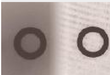
Bild 4: Gemeinsame Abbildung der ringförmigen Passermarken auf dem Substrat (links) und auf dem Sieb (rechts). Man erkennt deutlich die Siebstruktur in der rechten Bildhälfte und die Inhomogenität des Untergrundes, insbesondere im Überlappungsbereich in der Bildmitte.
