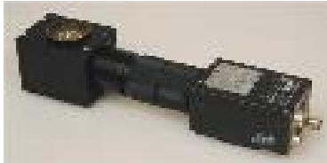
Bild 3: Die Abbildung zeigt ein Foto des optischen Sensors. Im linken Bildteil sieht man den Lichteintritt und die Ringleuchte für den Blick nach oben sowie das Gehäuse für das Strahlteilungsprisma. In der Mitte ist das telezentrische Objektiv zu sehen und rechts die hochauflösende Kamera.
