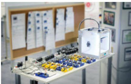
Vernetzt mit 3D-Drucker: Arduinos mit Sensoren für Licht-, Temperatur- und Bewegungsmessung in der ROI IoT Fab
