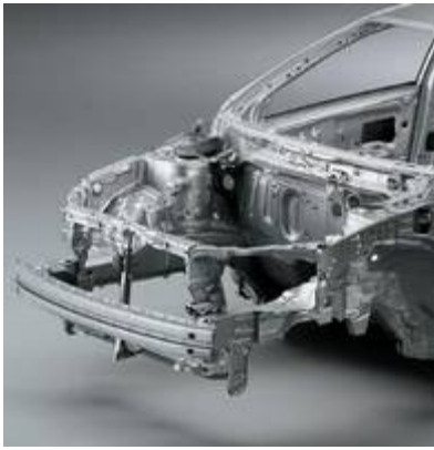
Abbildung 11: Rohkarosse Vorderwagen des Toyota Corolla 2008 (links, Toyota), Karosserie- Montageträger (rechts, aus [KHo06])
