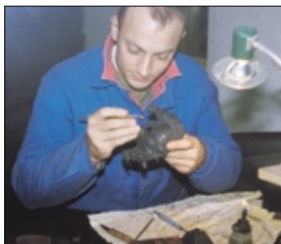
Dalís Skulptur „Rhinocéros“: Vom fertigen Guss werden Wachsreste entfernt.
