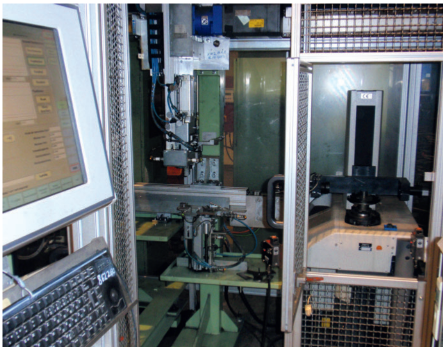
Bild 1. Die Präzisionsmessmaschine wurde in eine vollautomatische Produktionszelle integriert.
