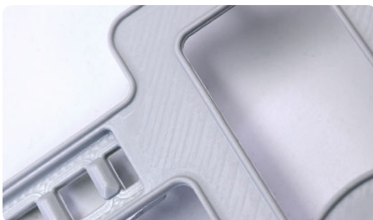
Bild: Sichtflächen auf Kunststoffteilen sind meist mit einer Struktur versehen. Auf den nicht sichtbaren Oberflächen können Frässpuren sichtbar bleiben, um die Kosten des Formbaus gering zu halten.
