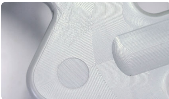
Bild: Kunststoffteile werden nach dem Spritzgießen mit Auswerfern aus der Spritzgießform geworfen. Die Auswerfer sollten nicht auf sichtbare Flächen ansetzen, da diese dort kreisrunde Abdruckstellen hinterlassen./ Hersteller: Froli
