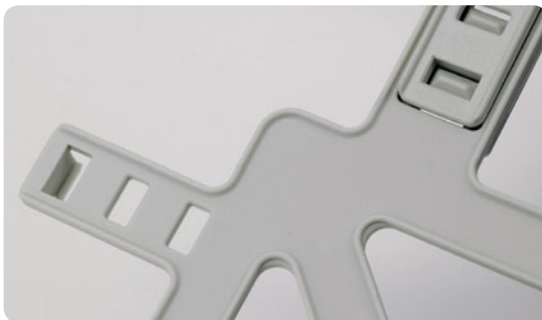
Bild: Mit einfachen Spritzgießwerkzeugen können Schnapphaken zur Verbindung von Bauteilen gefertigt werden. Der Hinterschnitt im Schnapphaken wird durch eine Öffnung ermöglicht, durch die das Werkzeug (»Schieber«) den Haken formen kann./ Beispielteile: Froli
