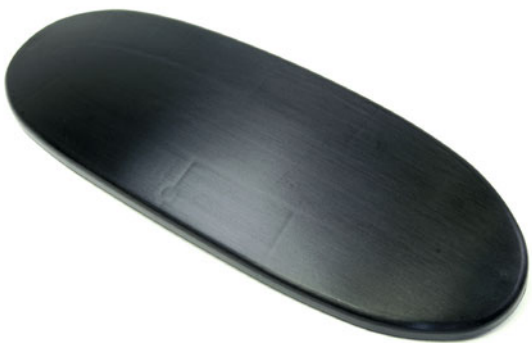
Bild: Einfallstellen auf der Außenseite. Dieses Bauteil wird anschließend mit einem weiteren, weichen Material umspritzt, so dass die Einfallstellen kaschiert werden.
