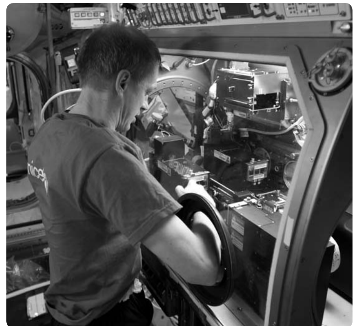
ESA Astronaut Frank de Winne arbeitet an der Microgravity Science Glove Box (MSG)
