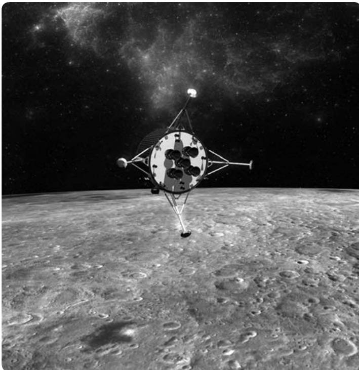
Lunar Lander – Phase B1 Studie eines automatisierten Mondlandefahrzeugs bei der Einleitung des Landevorgangs
