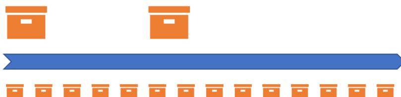
Abbildung 5: Viele kleine Behälter lassen Bedarfe und Material besser fließen als wenige große
