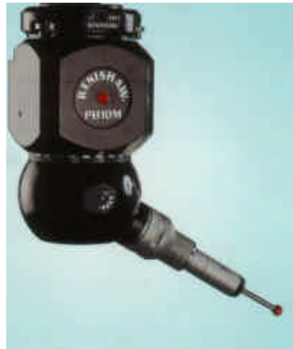
Bild 1: Links: Portalmessmaschine. Oben: Detailansicht eines in der Messmaschine verwendeten Tasters. (Bildquelle: Wenzel Präzision, www.wenzel-cmm.com ).
