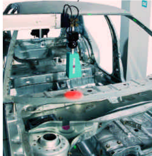
Bild 4: Beispiel für eine typische Anwendung des optischen 3D-Sensors PHOENIX zur Vermessung einer Automobilkarosserie. Der Sensor ist an die Standard-Aufnahme (Renishaw) einer Messmaschine des Herstellers Wenzel Präzision montiert.
