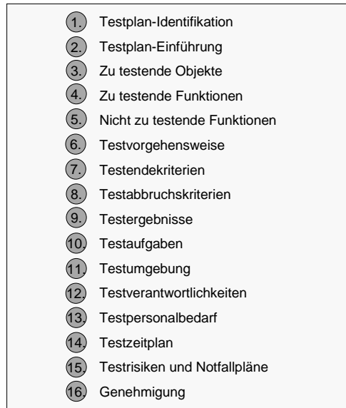
Abbildung 3.10 Aufbau des Testplans (nach ANSI/IEEE-Standard 829)
