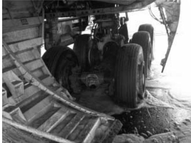
Bild 6: Das Flugzeug kommt am Ende der Landebahn in einem Sumpf von unter hohem Druck austretenden Kerosin mit 900 Grad heißen Bremsen zum Stehen: Wie durch ein Wunder entstand kein Brand!
